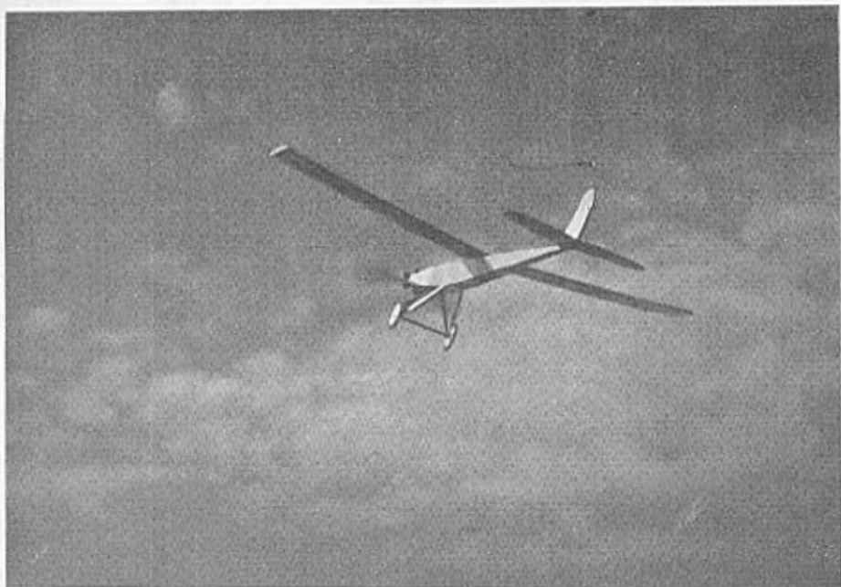
Modello volante del « Fiat A. S. 1 » con motore ad elastico.
