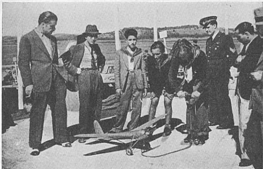
Si « gonfia » un aeromodello con motore ad aria compressa costruito nel 1936.
