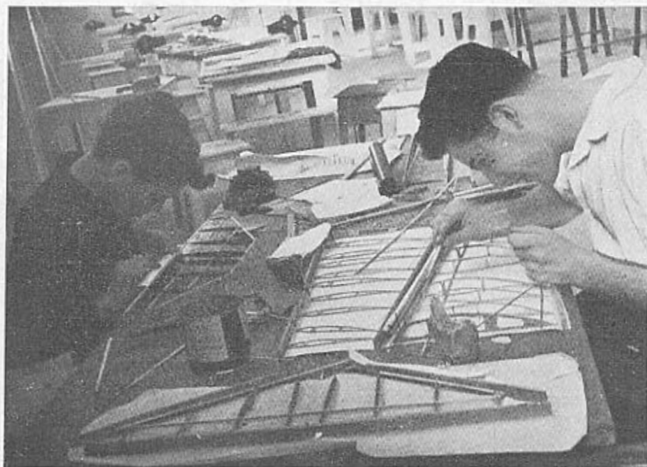
Togliendo una cèntina per volta, l'aeromodellista pone una goccia di colla sul listello inferiore e sul bordo d'attacco nel punto del loro incastro.
