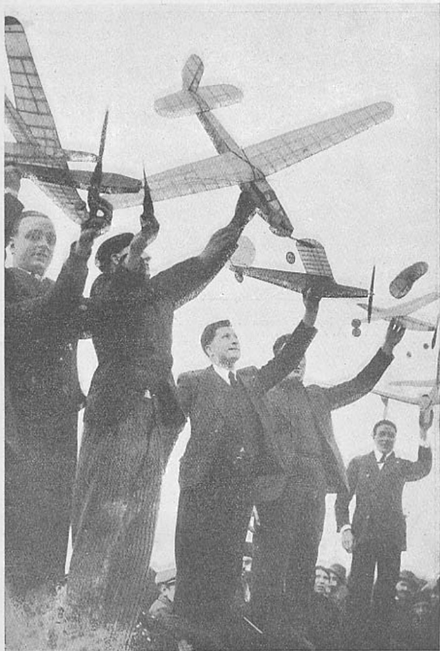
Alcuni tipi di aeromodelli francesi a fusoliera. Si tratta di costruzioni quasi sempre interamente in balsa e con eliche a grande passo.
