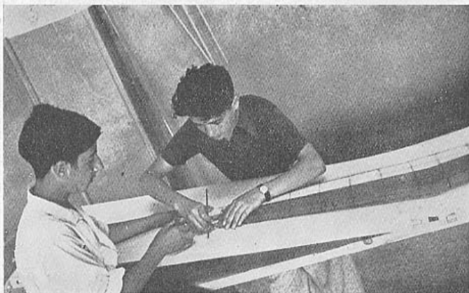
Le ultime operazioni per il rivestimento di un'ala...
