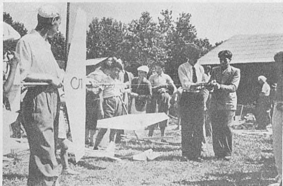
...agganciata l'elica al trapano a mano, con l'aiuto di un compagno si tende la gomma tre volte la sua lunghezza per poter incominciare ad attorcigliarla.
