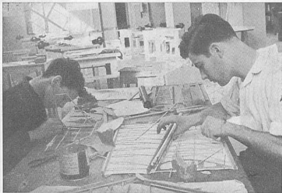
La cèntina viene ricollocata al suo posto incastrandola nel bordo d'attacco e nel longerone inferiore.
