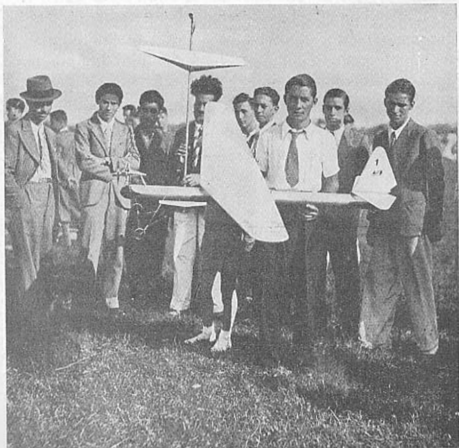
Aeromodello ad aria compressa con serbatoio-fusoliera cilindrico.
